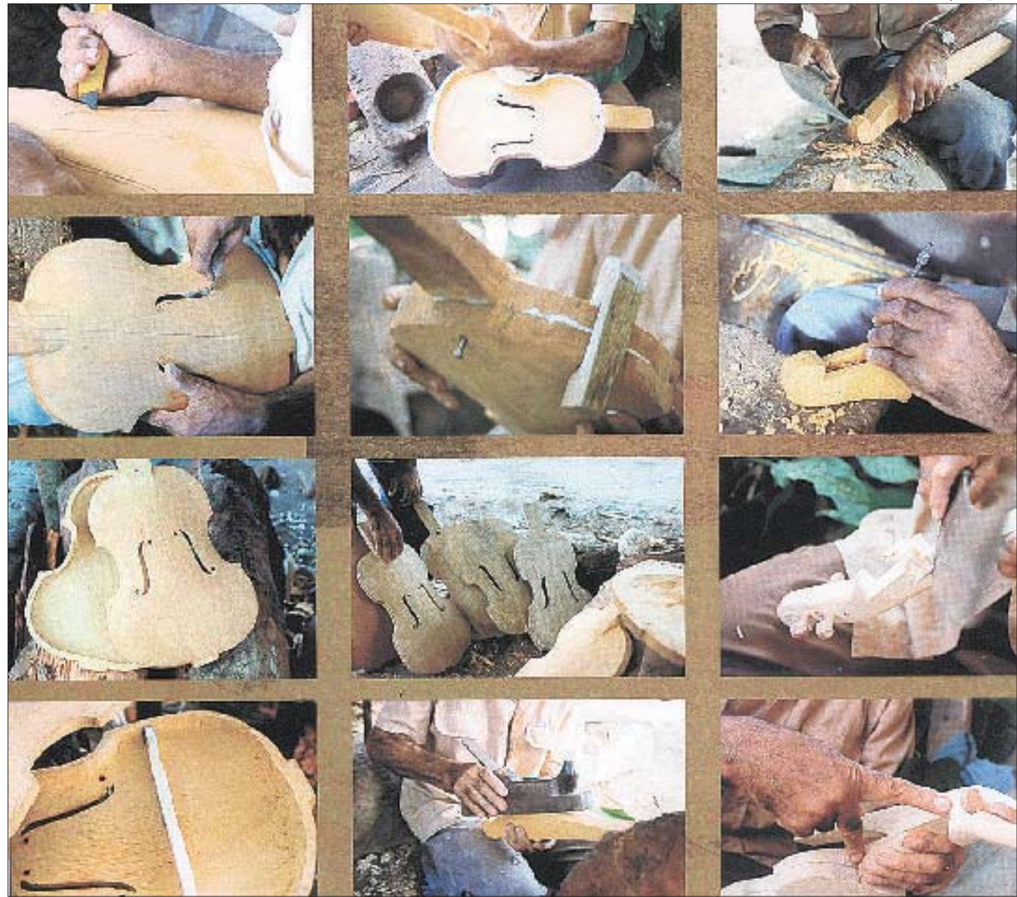
O mestre construtor de rabeças Nelson Santos, de Marechal Deodoro, Alagoas, parte o trabalho do tronco do jacarandá
